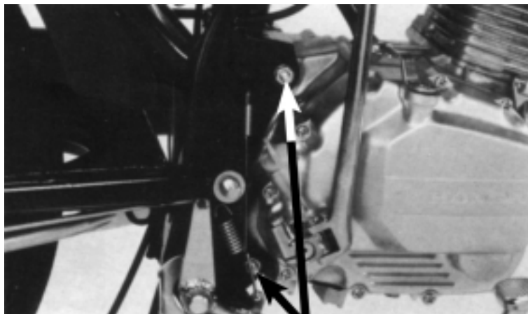
PARAFUSOS DO SUPORTE TRASEIRO DO MOTOR
